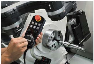
自動運転、手動運転を問わず、衝突前に動作停止します
