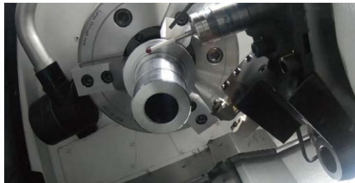
写真はLB3000 EX Ⅲ Y軸仕様機によるY軸方向の測定
